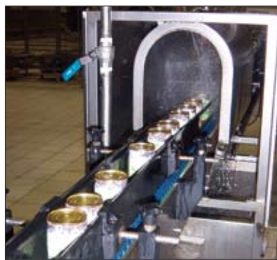
FOTO: Línea de tratamiento térmico (M. A. Serrano)
